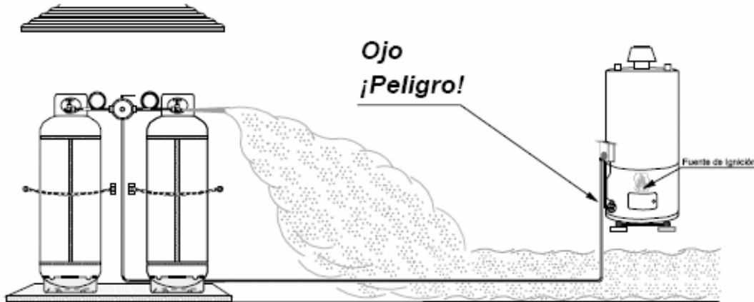
Figura 4. – Desplazamiento típico de una fuga de gas licuado
